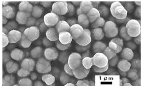
ウニ状酸化チタン ST-750 電子顕微鏡写真
